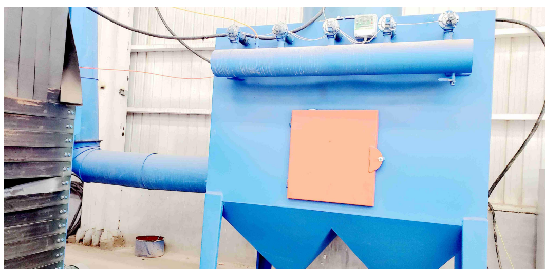
图 3-2 抛丸机配套除尘器
