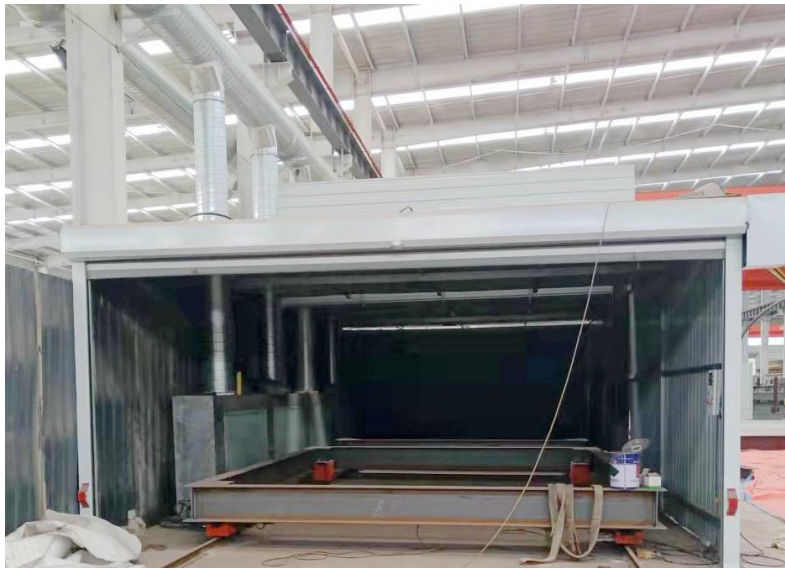
图 3-3 切割、焊接、抛丸最终共用除尘器
