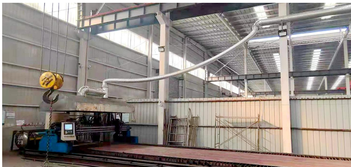
图 3-1 焊接、切割集气罩
