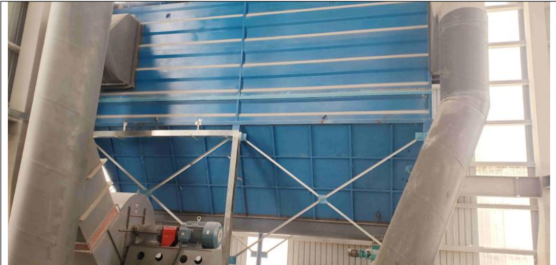
图 3-7 超细研磨粉生产线球磨除尘器
