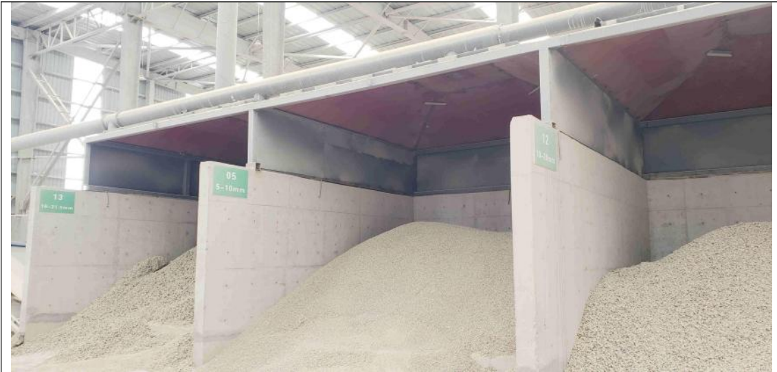
图 3-3 水泥稳定碎石生产线上料集气罩
