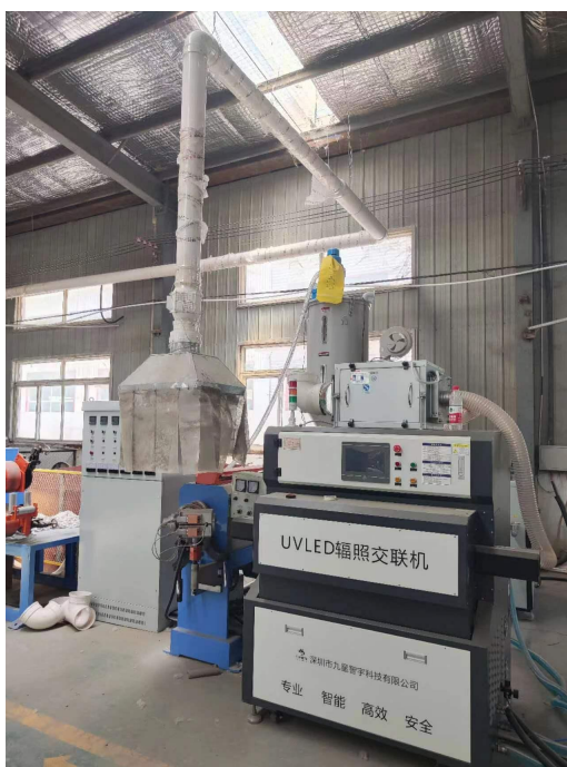
图 3-1 新增的塑料挤出机
