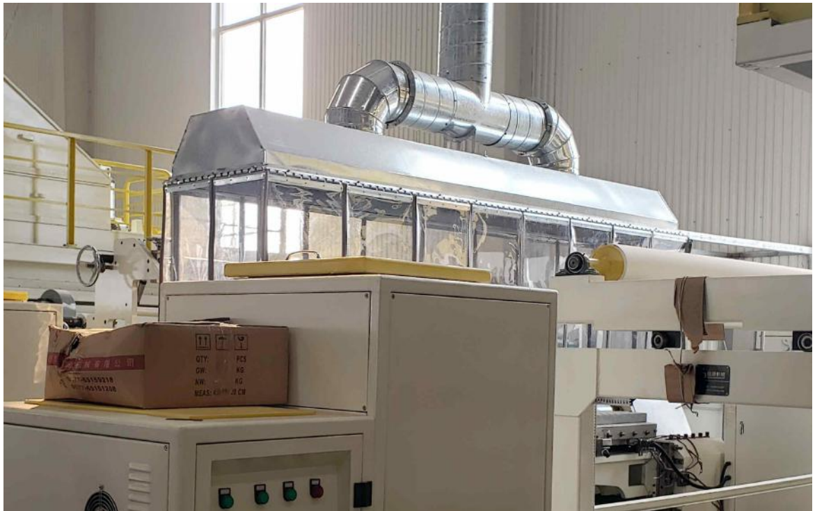
图 3-2 溶胶、涂布工序集气罩
