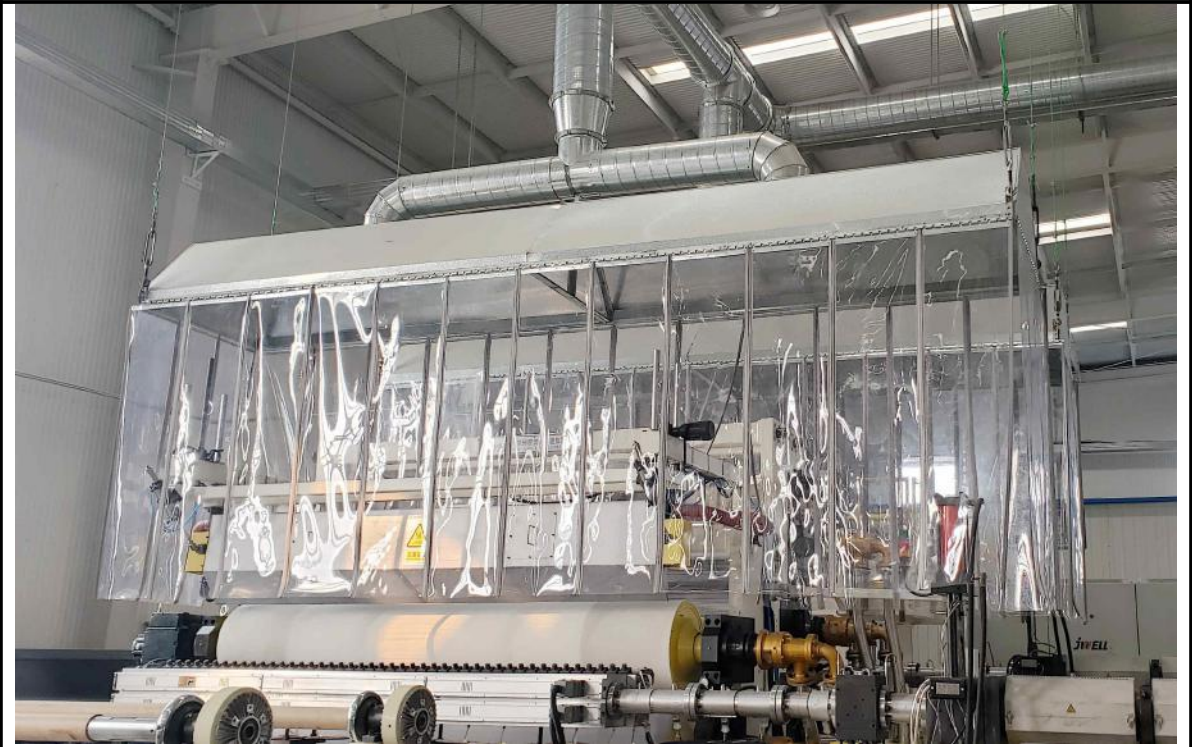
图 3-1 熔融挤出工序集气罩
